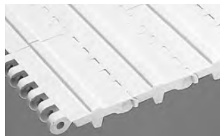
SERIA 800 MINI RIB • Napęd centralny • Zawias otwarty • Podziałka 2,00 cale (50,8 mm)
