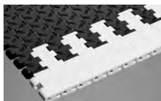
SERIA 1400 NON SKID • Napęd centralny/przegubowy • Zawias zamknięty • Podziałka 1,00 cal (25,4 mm)
