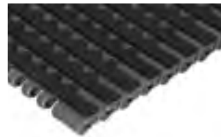
SERIA 1000 • Napęd centralny/przegubowy • Zawias zamknięty • Podziałka 0,60 cala (15,2 mm)
