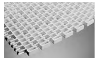
SERIA 2600 (3.2) • Napęd przegubowy • Zawias otwarty • Taśma skrętna • Podziałka 2,00 cale (50,8 mm)
