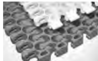
SERIA 2200 • Napęd przegubowy • Zawias otwarty • Taśma skrętna • Podziałka 1,50 cala (38,1 mm)
