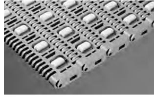
SERIA 400 TRANSVERSE ROLLER TOP • Napęd centralny • Zawias zamknięty • Podziałka 2,00 cala (50,8 mm)
