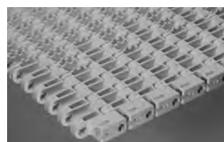
SERIA 1700 NUB TOP • Napęd centralny/przegubowy • Zawias zamknięty • Podziałka 1,50 cala (38,1 mm)
