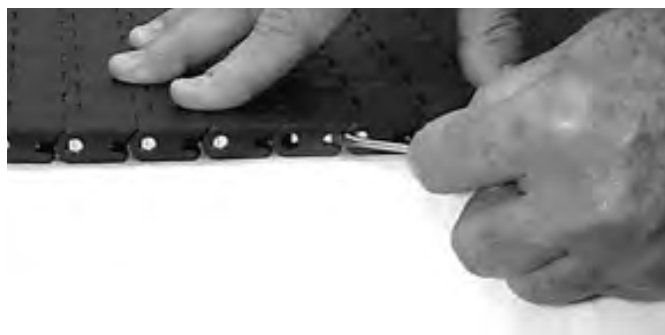
Rys. 2-29 Taśma serii 1400 z systemem Slidelox®
