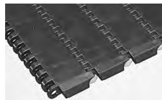
SERIA 900 • Napęd centralny • Zawias zamknięty • Podziałka 1,07 cale (27,2 mm)
