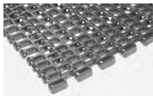
SERIA 2600 (2.2) • Napęd przegubowy • Zawias otwarty • Taśma skrętna • Podziałka 2,00 cale (50,8 mm)
