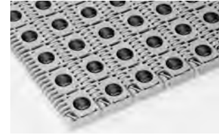
SERIA 400 0° ANGLED ROLLER • Napęd centralny • Zawias zamknięty • Podziałka 2,00 cala (50,8 mm)
