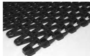
SERIA 2600 (1.0) • Napęd przegubowy • Zawias otwarty • Taśma skrętna • Podziałka 2,00 cale (50,8 mm)
