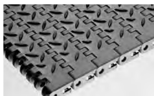
SERIA 1200 NON SKID • Napęd centralny • Zawias zamknięty • Podziałka 1,44 cala (36,6 mm)
