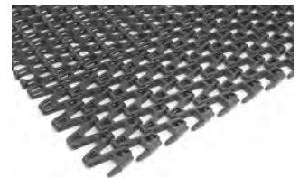
SERIA 2600 (1.1) • Napęd przegubowy • Zawias otwarty • Taśma skrętna • Podziałka 2,00 cale (50,8 mm)
