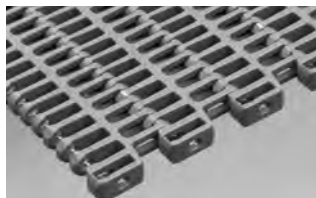
SERIA 2700 (2.2) • Napęd przegubowy • Zawias otwarty • Taśma skrętna • Podziałka 2,00 cale (50,8 mm)
